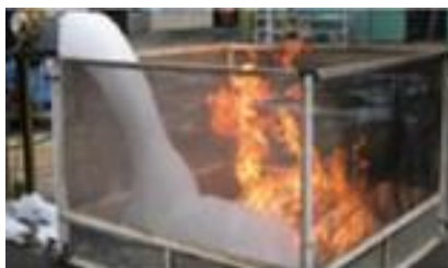
【泡消火実験の様子】
